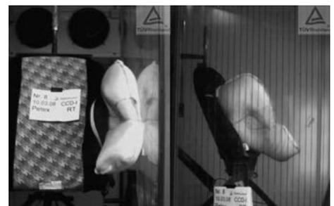
Bilder einer High-Speed-Kamera bei einem sog. „Airbag-Entfaltungsversuch“
